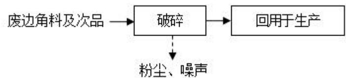
图 2-3 项目废边角料及次品回用工艺流程及产污环节图
