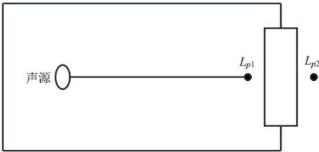
图 4-1 室内声源等效为室外声源图例
