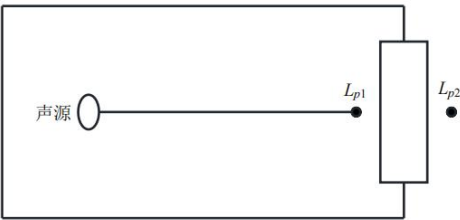
图 4-1 室内声源等效为室外声源图例
