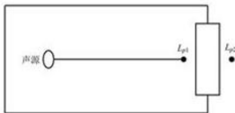
图 4-4 室内声源等效为室外声源图例
