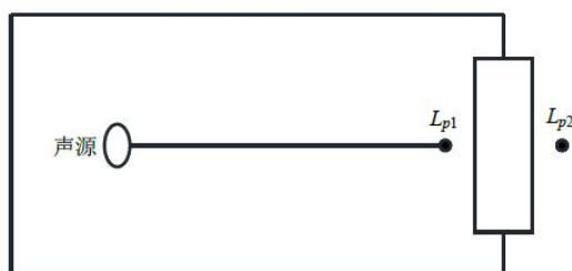
图 4-2 室内声源等效为室外声源图例
