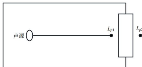
图 4-2 室内声源等效为室外声源图例
