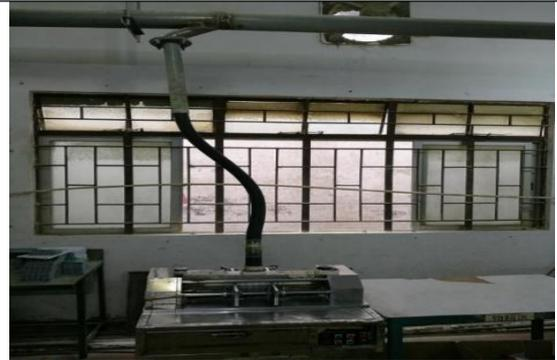
成型工序废气收集管道
