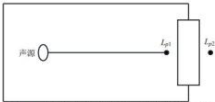
图 4-1 室内声源等效为室外声源图例
