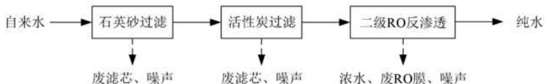
图 2-15 纯水制备工艺流程及产污环节图
