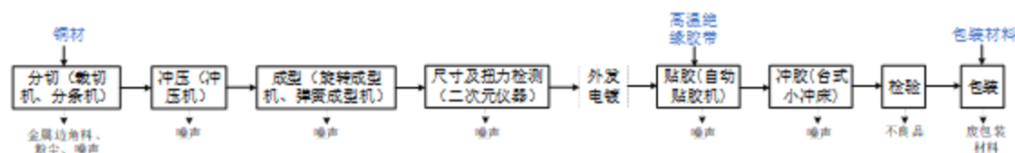
图 2-3 项目电源铜片、铜圈生产工艺流程图
