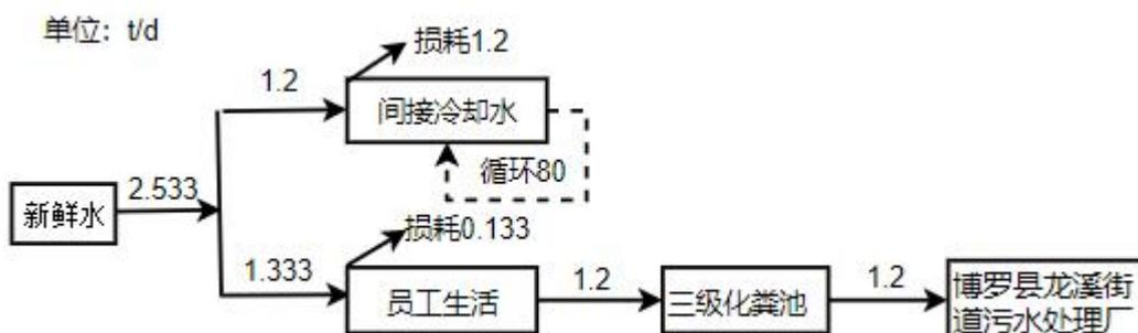
图 2-1 现有项目水平衡图 (单位: t/d)
