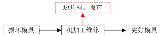
图 2-8 模具维修工艺流程及产污环节图
