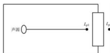
图 4-1 室内声源等效为室外声源图例
