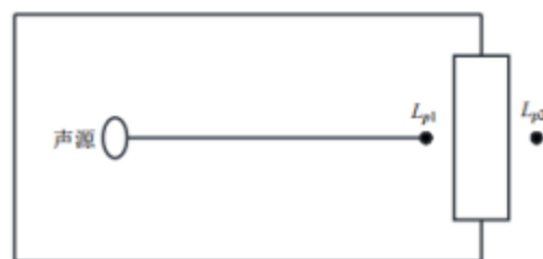
室内声源等效为室外声源图例
