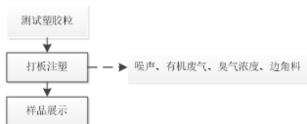
图2-6 项目塑胶样品测试工艺流程图
