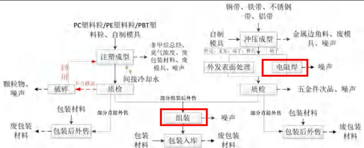
图3 项目外壳、支架、端子、刷子、弹片和塑胶制品生产工艺流程图
