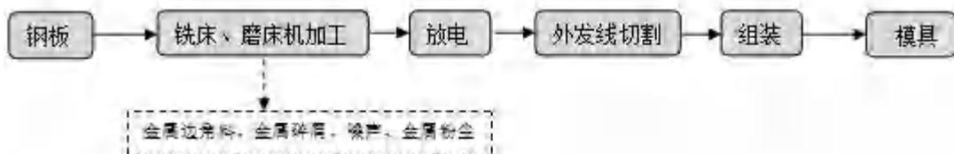
图2 项目模具生产工艺流程图及产污节点图
