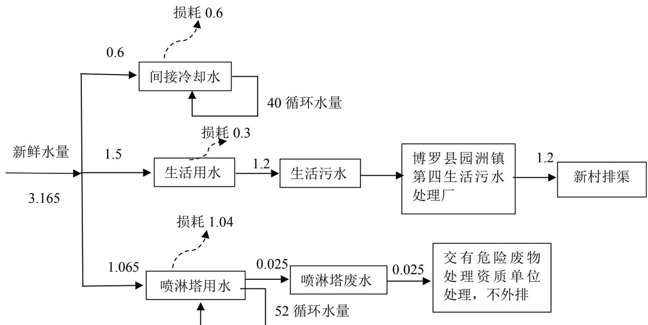
图 2-1 项目水平衡图 (m<sup>3</sup>/d)
