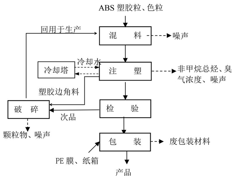
图 2-2 项目耳机配件生产工艺流程图
