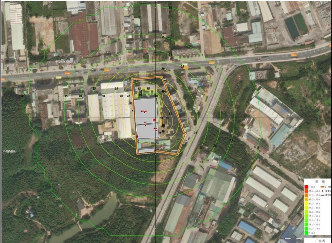
图 4-2 正常工况声环境影响预测结果图 注：等声级线图
