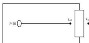
图 4-1 室内声源等效为室外声源图例
