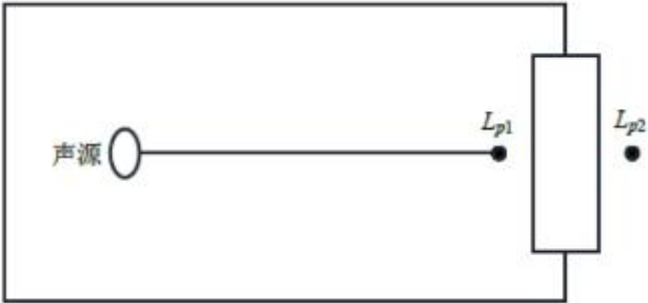
图 4-1 室内声源等效为室外声源图例
