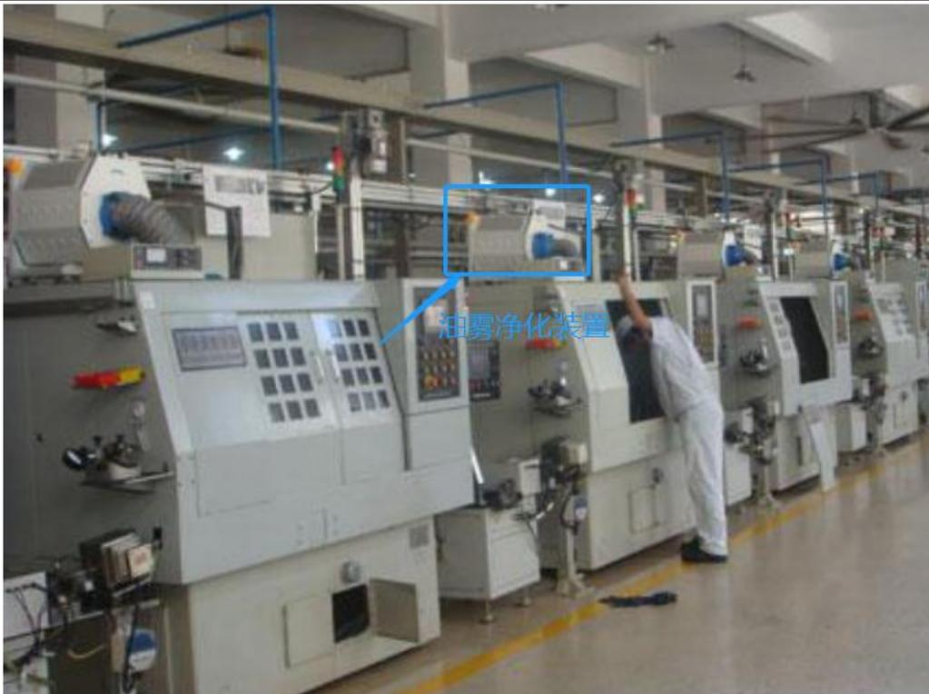
图 4-1 同类型数控机床油雾废气收集处理示意图
