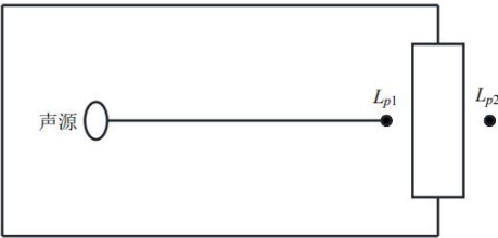
图 4-1 室内声源等效为室外声源图例
