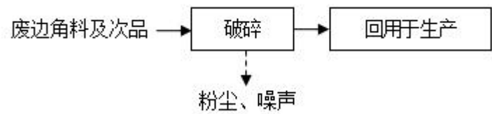
图 2-3 项目废边角料及次品回用工艺流程及产污环节图
