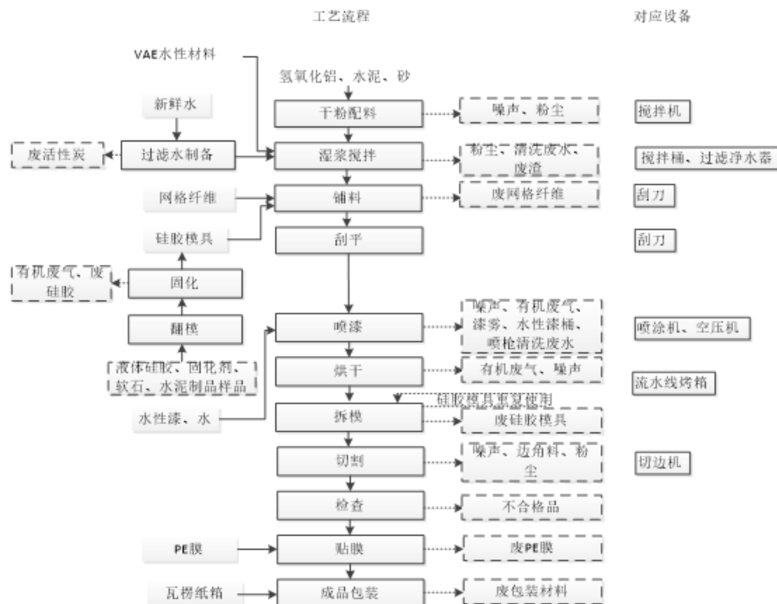
图2-3 生产工艺流程及产污环节
