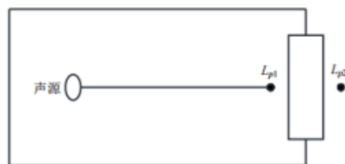
室内声源等效为室外声源图例
