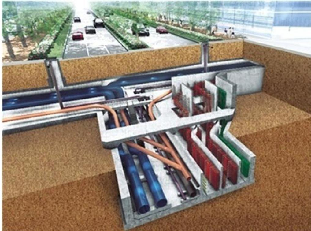
图8-4 综合管廊交叉节点三维示意图
